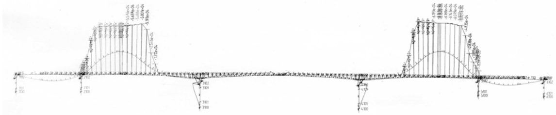
Hình 4: Biểu đồ mô men sơ cấp khi kéo dự ứng lực hợp long nhịp kế biên
